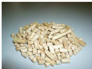
Склеивание происходит за счет содержания в древесине лигнина, который при нагревании обеспечивает формирование требуемой формы. Иными словами, это те же **дрова**, в удобной для транспортировки, хранения и применения форме.
